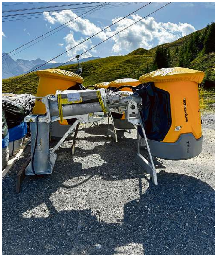
Die neuen Schneeerzeuger der technischen Beschneigung.
